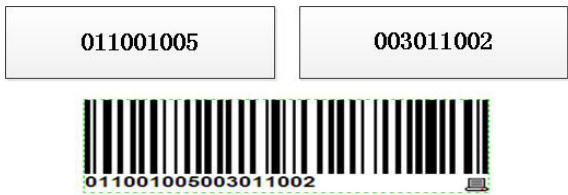
图 1 配线关系条码识别原理图
